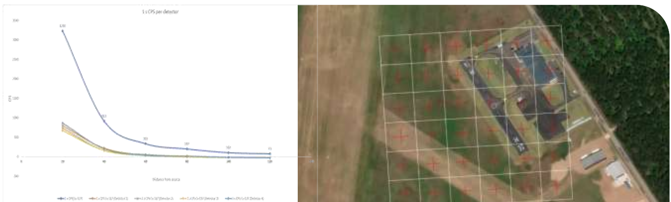
32 pav. Bandomųjų skrydžių su VSAT silpimo koeficiento jonizuojančiosios spinduliuotės silpimo koeficientui ir jautrumui aptikti iš oro radioaktyvųjų šaltinį nustatyti ant žemės pavyzdys
