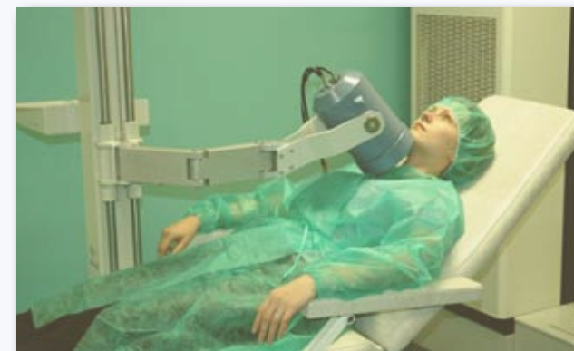
5 pav. Radionuklidų aktyvumo matavimas skyd liaukės matuoekliu
