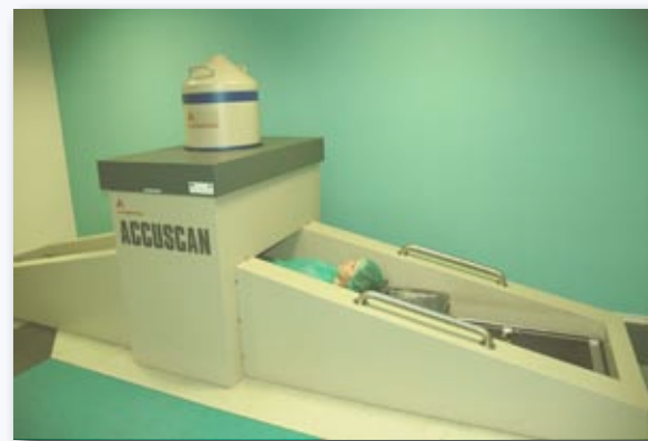
4 pav. Radionuklidų aktyvumo matavimas viso kūno matuoekliu
