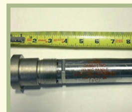
3 pav. Neutronų uždarys ^{241}\text{Am/Be} šaltinis, naudojamas gręžinių tyrimo įrenginiuose
