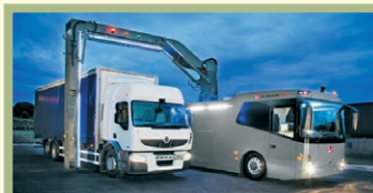
9 pav. Krovinių saugumo kontrolės prietaisai (introskopas)
