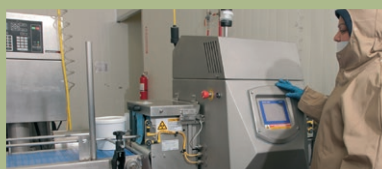
8 pav. Svetimkūnių aptikimo produkcijoje rentgeno įrenginys (introskopas)
