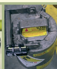
4 pav. Uždaryjū šaltinių, naudojamų gręžinių tyrimo įrenginiuose, transportavimo konteineris
