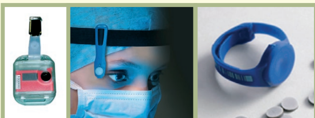
4 pav. Individualieji dozimetrai, skirti viso kūno, akių ir rankų apšvitos dozėms matuoti
